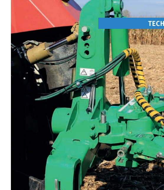
Im Drehwerk hatte unser Testpflug die größere Achse mit 130 mm Durchmesser eingebaut.
