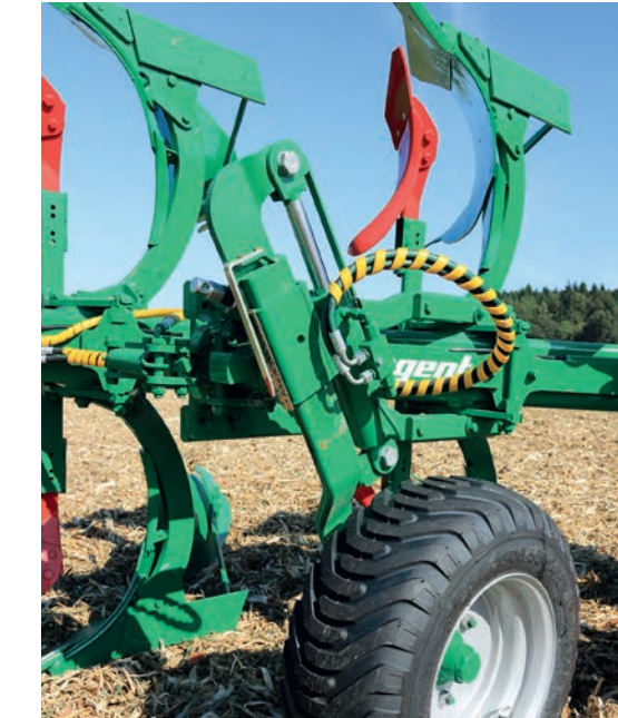
Das Pendelstützrad (und damit die Arbeitstiefe) ist von der Kabine aus verstellbar.
