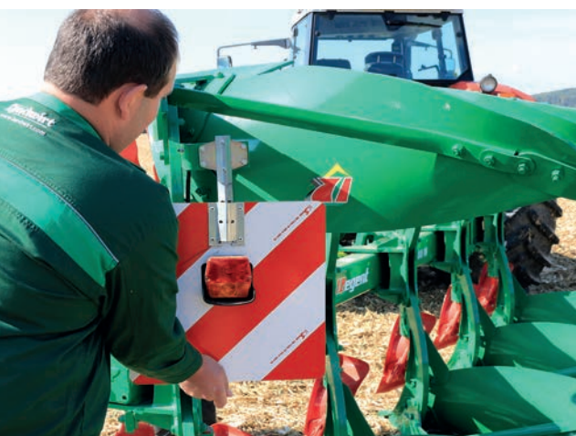
Die Warntafel ist schnell abnehmbar, leider fehlt eine Parkposition am Pflug. Fotos: Weninger
