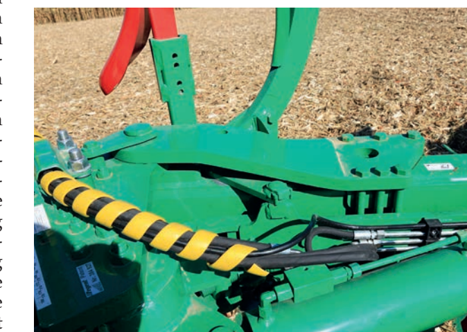
Die massiven Rahmentragplatten erhöhen die Stabilität.
