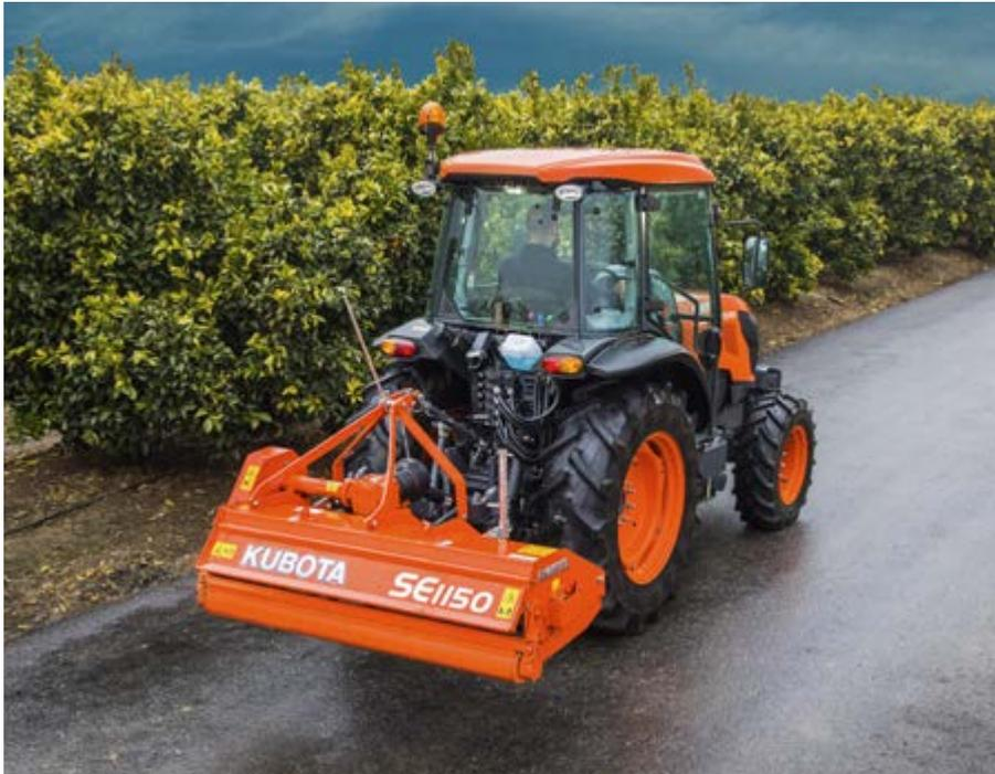
Mehr Kraft und Leistung für alle Aufgaben lautet das Motto für das Hubwerk des M5001N. Mit dem stabilen 3-Punkt-Kraftheber der Kategorie II kann der Traktor schwere Geräte locker heben. 2.300 kg Hubkraft sprechen für sich. Das Plus an Hubkraft werden Sie bei solchen Einsätzen zu schätzen wissen, bei denen Ihr bisheriger Traktor an seine Leistungsgrenzen angelangt ist.
