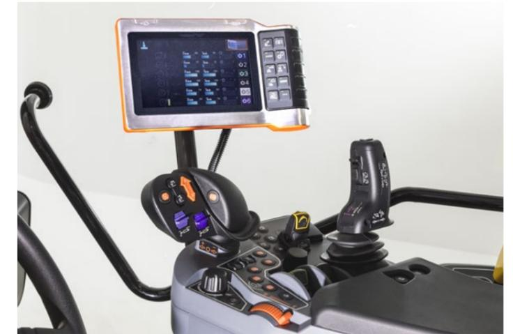
Beim Kubota M7003 können Sie optional alle Bedienelemente in die moderne Armlehne integrieren. Alle Bedienelemente, die Sie regelmäßig brauchen, haben Sie in Reichweite, ohne dafür den Arm heben zu müssen. Das bedeutet für Sie noch mehr Komfort und ein Plus an Produktivität – intuitive Bedienung inklusive.
