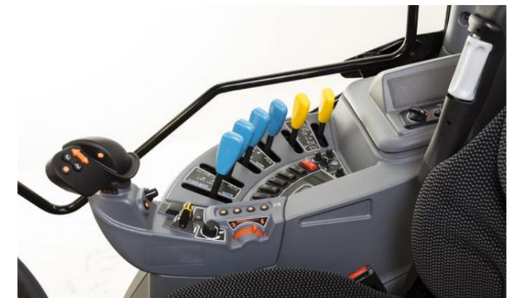
Bei allen Modellen des M7003 befinden sich einige zusätzliche Steuerungen zentral auf der rechten Seite. Der Multifunktionshebel beim Standardmodell ist in die seitliche Bedienkonsole integriert, während die höheren Modelle mit einer modernen Armlehne mit Multifunktionshebel ausgestattet sind.
