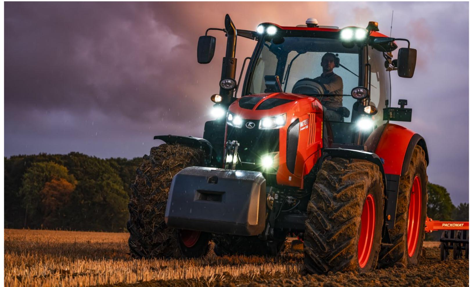
Vorderachs- und Kabinenfederung schonen Mensch und Maschine gleichermaßen und haben eine hohe Produktivität zur Folge. Apropos Vorderachse: Mit der DANA 745 ist der M7003 mit einer extrem robusten Frontachse ausgestattet. Der Traktor ist ohne Kabinenfederung erhältlich oder kann mit zwei unterschiedlichen Federungssystemen ausgestattet werden: einem mechanischen Federungssystem oder einer pneumatischen Federung.
