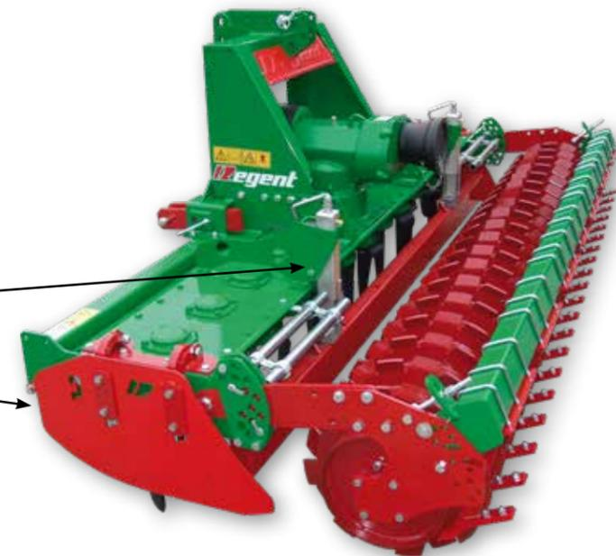
Abb. Aress 3000 mit Krümenpackerwalze
